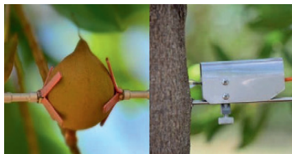
Grafika 37. 1. Czujnik monitorujący wzrost i mikrozmiany w obrębie nienaruszonych owoców. 2. Dendrometr śledzący, w jaki sposób rośliny reagują na swoje środowisko w wysokich rozdzielczościach czasowych.
