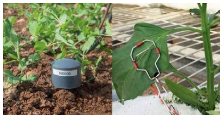
Grafika 36. 1. Czujnik określający zawartość wody w glebie. 2. Czujnik mierzący bezwzględną temperaturę liścia.
