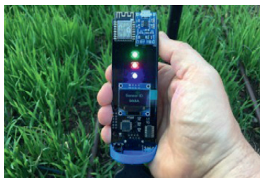
Grafika 38. Narzędzie Chameleon soil water sensor. Źródło: https://www.csiro.au/en/research/plants/crops/farming-practices/chameleon-soil-water-sensor .
