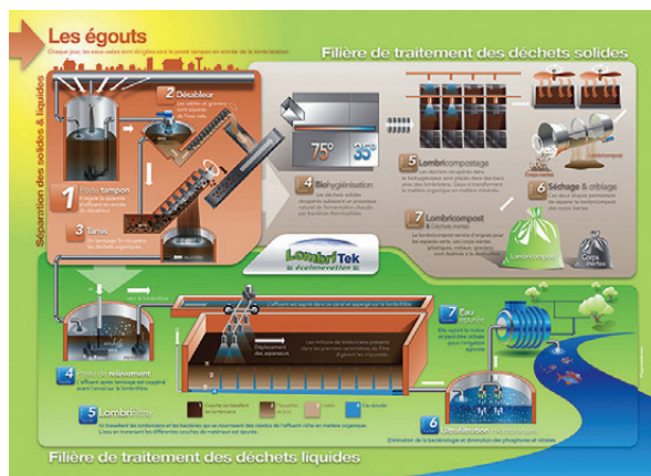
Grafika 22. Schemat funkcjonowania lombristacji; opracowane własne na podstawie grafiki opublikowanej na stronie LombriTek. Źródło: http://lombritek.com/lk/index.php/eaux-usees-2/ .
